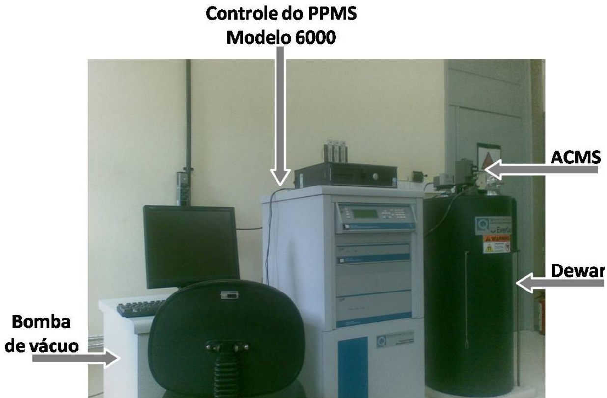
Figura 4.2 – PPMS® Quantum Design preparado com o sistema ACMS.
