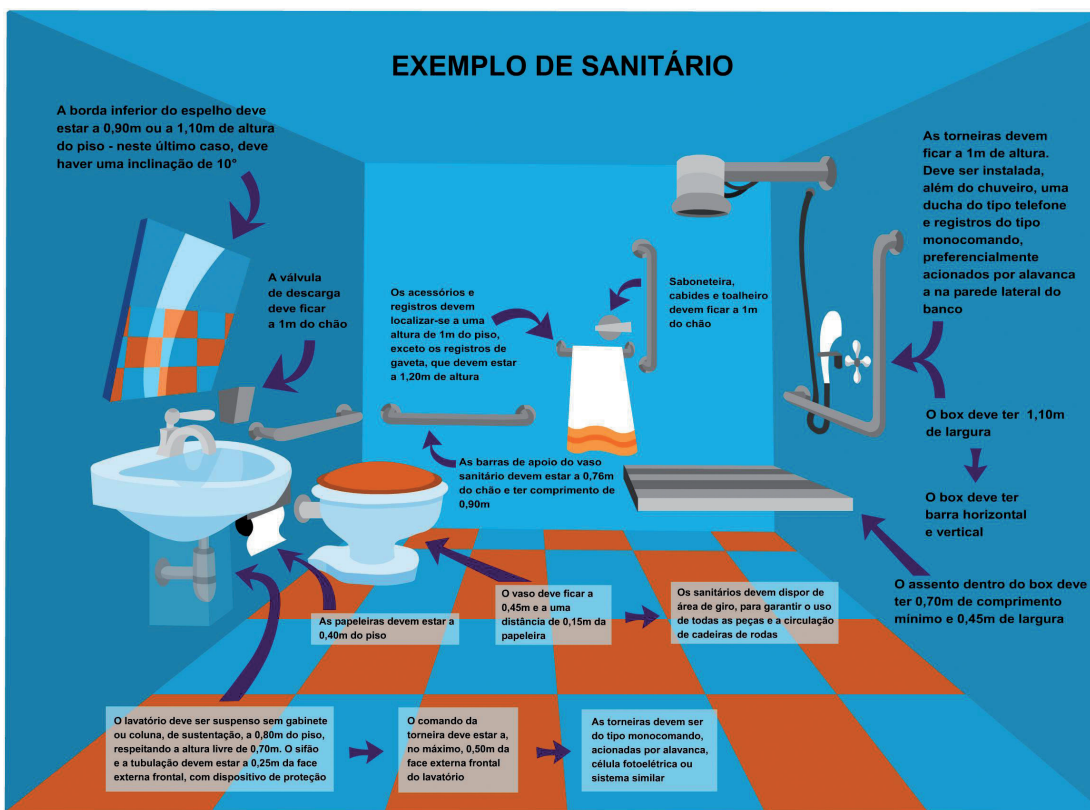
Exemplo de banheiro para deficiente
