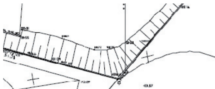
À esquerda, o recorte do levantamento topográfico, no qual aparece representado o barranco. À direita, a simbologia para barranco.
