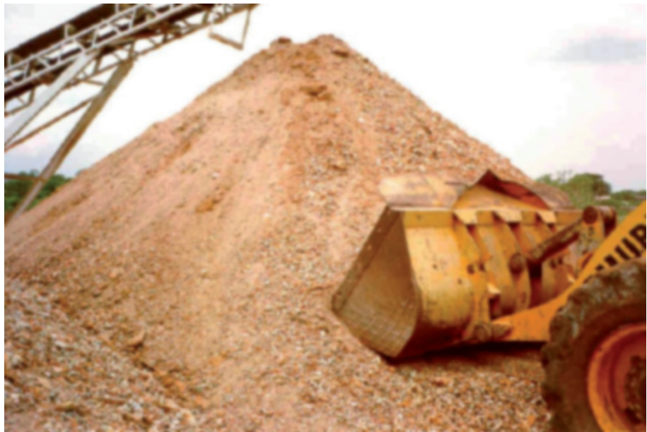
Reciclagem de entulho para fabricação de concreto. (Fonte: ZORDAN, 2007.)
