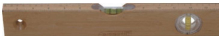
Nível em madeira. Obtém-se uma garantia de nivelamento quando a bolha de ar ficar entre as marcas existentes na ampola com líquido esverdeado.
