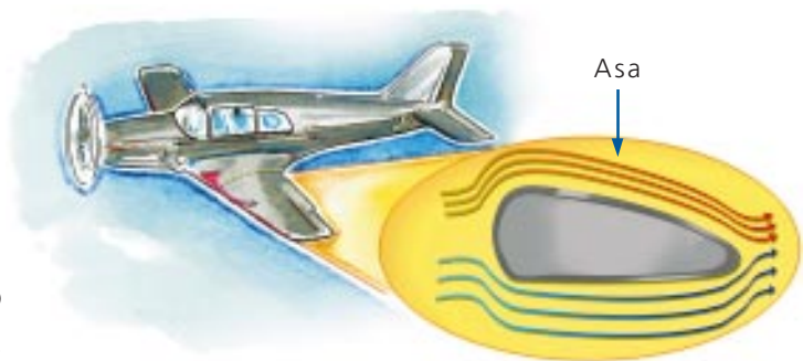
Figura 11: Perfil da asa do avião
