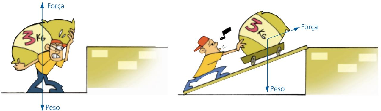
Uma rampa é um exemplo de plano inclinado. Pense na força que você faz para levar um objeto bem pesado do chão até uma certa altura. Se for possível empurrar esse objeto para cima por uma rampa, a força que você fará será menor. Em compensação, o caminho será mais longo. Ou seja, como máquina simples, o plano inclinado permite que você faça uma força menor, por uma distância maior.
