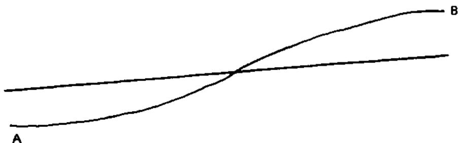
Dados : Cota do terreno em A : 448,323 Altura do aterro em A : 8,922 Rampa do greide entre A e B : + 3% Cota do terreno em B : 485,873 Estaca de A = 428 Estaca de B = 450
