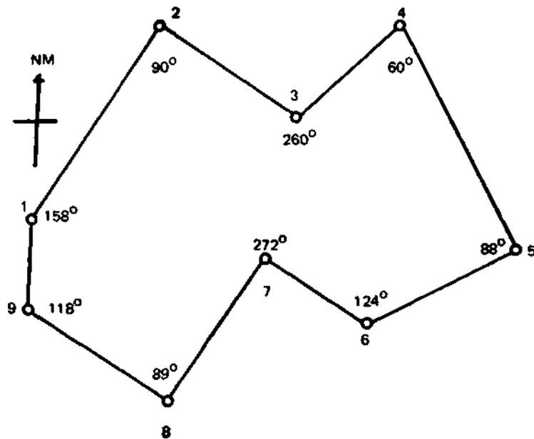
11. No croqui abaixo, de um levantamento por deflexões, calcule o erro angular de fechamento :
