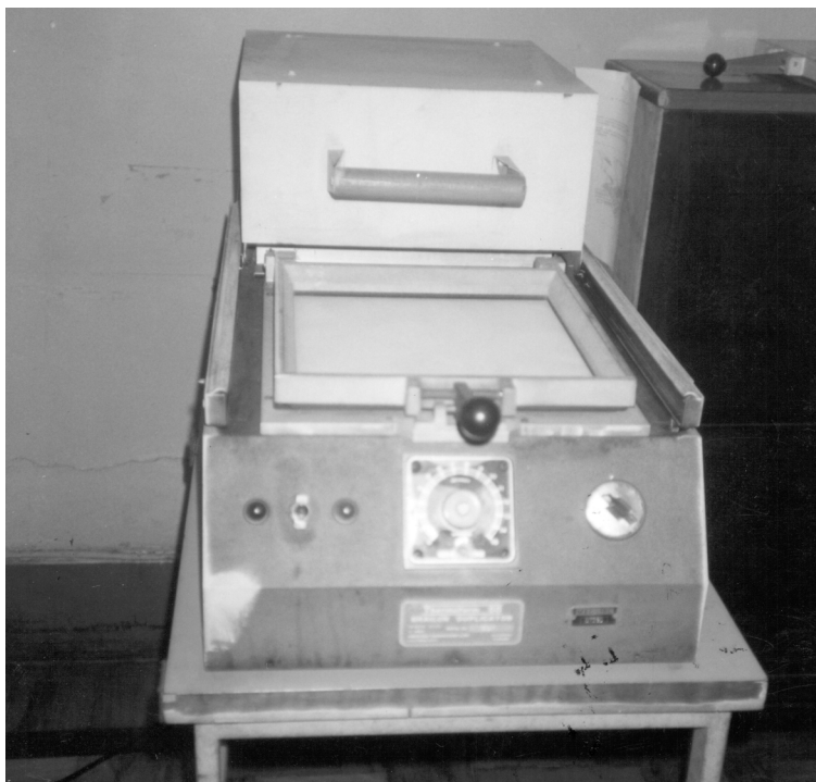
Thermoform - duplicador de textos e formas em relevo em lâminas de PVC
