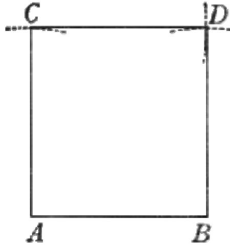
si formerà sopra la linea  $AB$  tirando la perpendicolare dal punto  $A$ , per la regola dichiarata di sopra; la quale perpendicolare sia  $AC$ , e taglisi eguale all' $AB$ ; ed allargando il compasso secondo la larghezza  $AB$ , fermata una delle sue aste ora nel punto  $C$  ed ora nel  $B$ , si farà l'intersecazione al punto  $D$ : dal quale prodotte le linee  $DC$ ,  $DB$ , sarà fatto il quadrato.
