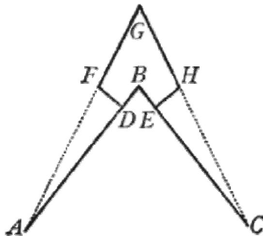
nella quale, sendo sopra l'angolo del ricinto  $ABC$  costituito l'angolo del baluardo  $FGH$ , quale di necessità è sempre minore dell'angolo del ricinto (come facilmente si può trarre dalla 21<sup>a</sup> proposizione del Primo d'Euclide), sendo dentro alle linee  $AGC$  dalli punti  $A, C$  costituite le due linee  $AB, BC$ , ogni volta che l'angolo  $B$  sarà o retto o acuto, l'angolo  $G$  sarà più acuto.
