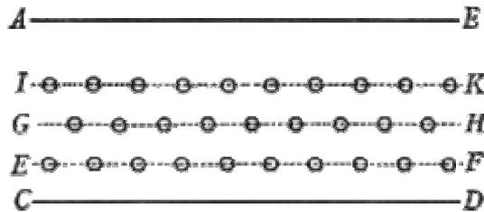
dove *AB* è il filo di fuori e *CD* quello di dentro, ed i pali vanno piantati secondo le linee *EF*, *GH*, *IK* con l'ordine che dimostrano i segni *O*. E basterà che detti pali siano fitti in terra solamente tanto che stiano dritti, perché, nel riempier poi di terreno, vanno sotterrati. Ma bisogna avvertire, che siano dritti e senza nodi, acciò che la incatenatura, che tra essi va intrecciata, possa senza impedimento abbassarsi, secondo che il terreno avvalerà.
