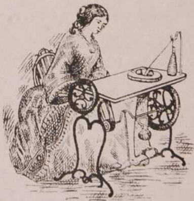
Modelo da machina de fazer meia, inventada em 1822, e de que resultou através de multiplicas transformações a actual machina de costura.
