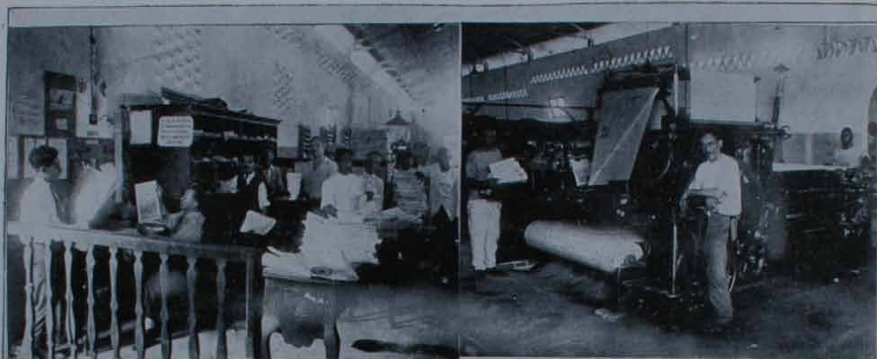
1 — Secção de Expedição, do "Diário do Estado" e da "Revista de Pernambuco". 2 — Machina Duplex, impressora do "Diário do Estado", na occasião de funcionamento.
