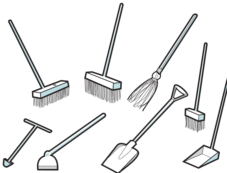
Figura 15 – Vassoura moderna, vassourão, vassoura de bruxa, vassoura pequena, chave para ralo, enxada para limpeza de ralo, pá quadrada e pá especial para varrição
