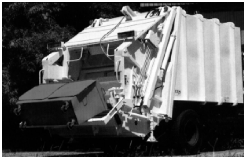
Basculamento de contêineres metálicos
