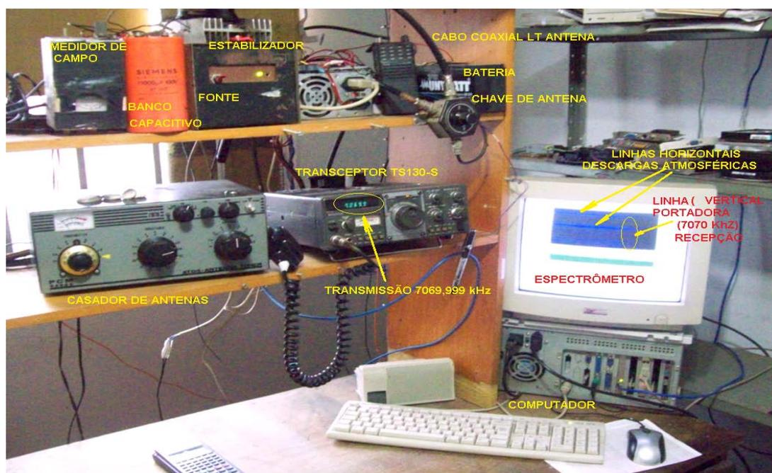
Figura 13: Laboratório de radiociência durante os preparativos de radiomonitoramento (Fonte: Leithold, A. A.; 2008)
