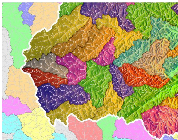
Figura 41: Detalhe das sub-bacias com shaded relief e o MNT.
