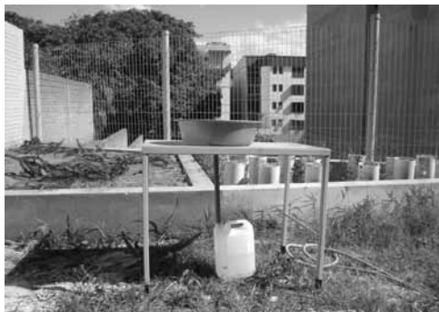
Figura 3 – Sistema de captação direta da água da chuva.
