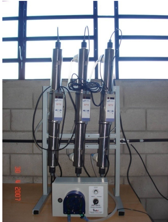
Figura 9: Fotorreatores de Luz UV adquiridos. Fonte: Rodriguez (2007).
