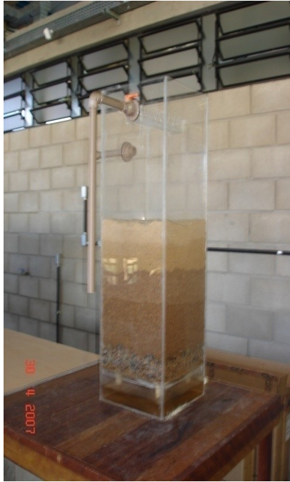
Figura 8: Filtro de areia utilizado. Fonte: Rodriguez (2007).
