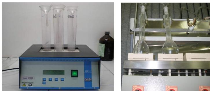
**Figura 8** - Sistema de digestão e destilação Kjeldhal para determinação do teor de proteínas totais nas amostras.
