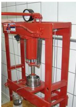
**Figura 3** - Prensa para a extração de óleo e produção de torta
