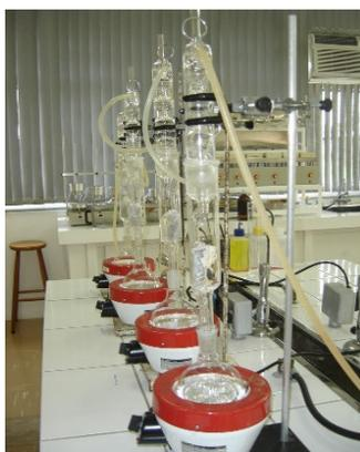
**Figura 6** - Extrator Soxhlet utilizado na extração de óleo residual.
