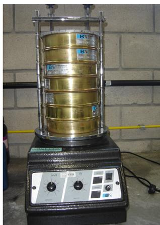
**Figura 7** - Sistema de peneiras para determinação da distribuição granulométrica das amostras.
