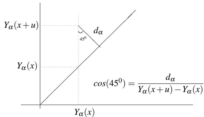
Figura 2.8: Ilustração geométrica da obtenção de um par de pontos do variograma empírico.  $d_\alpha$  representa a distância de um ponto separado de outro por uma distância  $u$  até a reta bissetriz de um diagrama de dispersão u-scatterplot.
