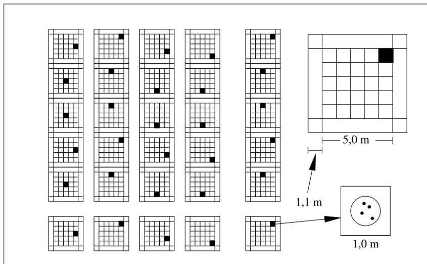
Figura 2.10: Esquema de mostragem com locação das parcelas e pontos amostrais em sistema desalinhado, sistemático estratificado proposto por Wollenhaupt e Wolkowski (1994) e adaptados por Souza et al. (1999).
