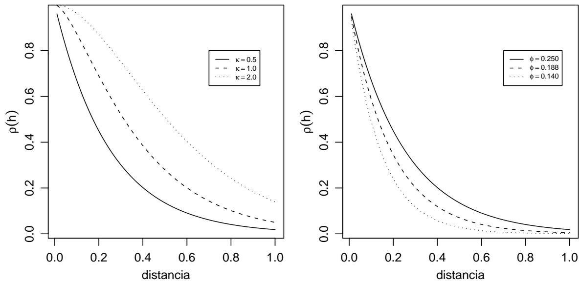
Figura 2.5: Comportamento da função de correlação de Matérn com o parâmetro  $\phi = 0,25$  fixo e diferentes valores para o parâmetro de diferenciabilidade  $\kappa$  (esquerda). Na mesma figura, para um mesmo valor de  $\kappa = 0,5$ , variou-se o parâmetro  $\phi$  que controla a taxa de decaimento da função (direita).
