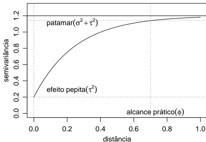
Figura 2.1: Comportamento padrão da função semivariância. Os elementos principais que a compõem são: o alcance prático proporcional a  $\phi$ , a variância de pequena escala ou efeito pepita  $\tau^2$  e a contribuição  $\sigma^2$  que corresponde à diferença entre o patamar e  $\tau^2$ .
