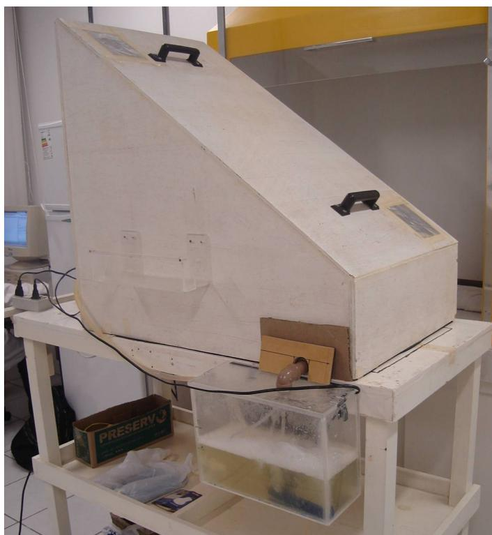
**Figura 4.** Vista lateral do reator de fotozonização em uso, com a cobertura de vedação.
