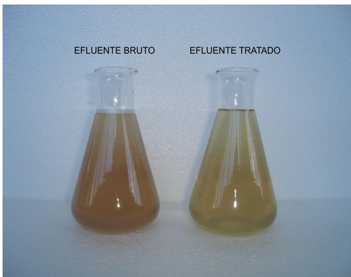
**Figura 12.** Foto mostrando o decolorimento do efluente pela aplicação do método UV/TiO<sub>2</sub>/O<sub>3</sub>.
