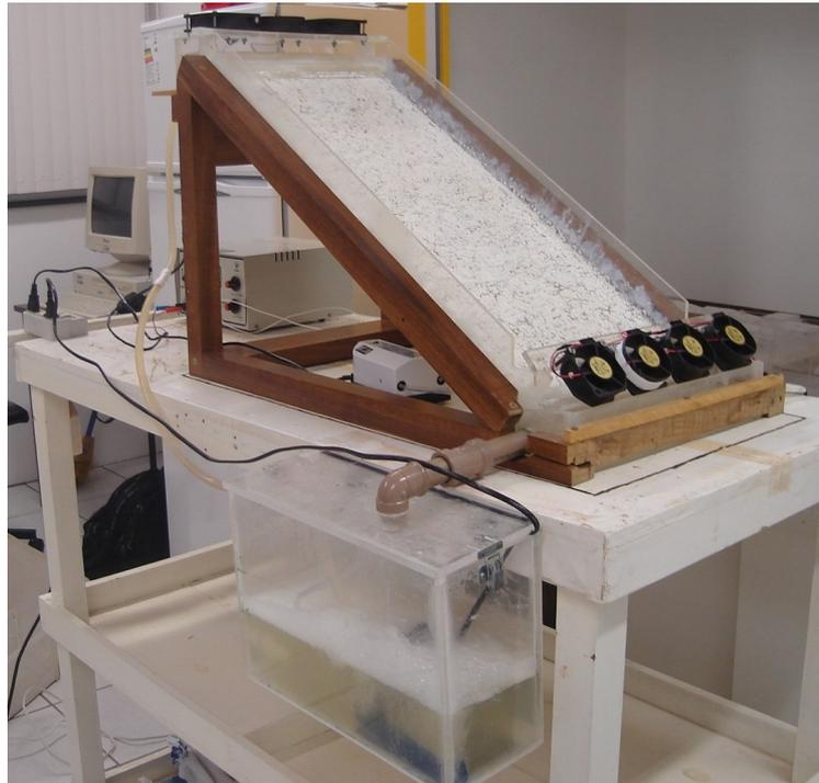
**Figura 6.** Reator de fotozonização em funcionamento, sem a cobertura de vedação.
