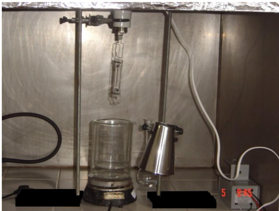
Figura 13 - Reator utilizado para degradação dos pesticidas.
