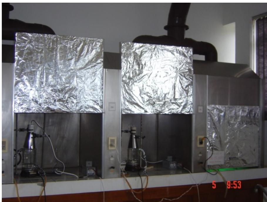
Figura 12 - Reatores em série utilizados para as degradações.
