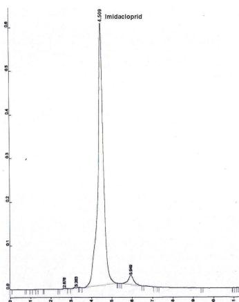
Figura 16 - Cromatograma obtido por CLAE do pesticida extraído da amostra B eluída em hexano:acetato de etila (7:3) e redissolvida em metanol.
