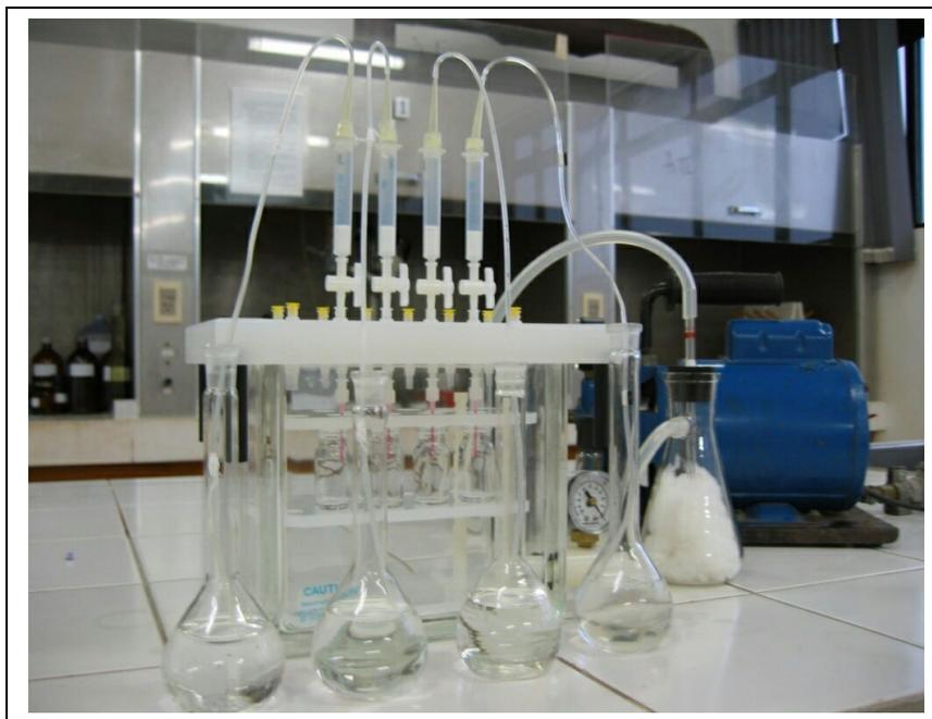
Figura 11 -Extração em Fase Sólida dos pesticidas do *float*
