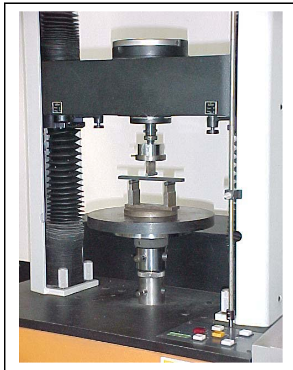
Figura 8. Fotografia do equipamento em um ensaio de flexão de 3 pontos de uma amostra.
