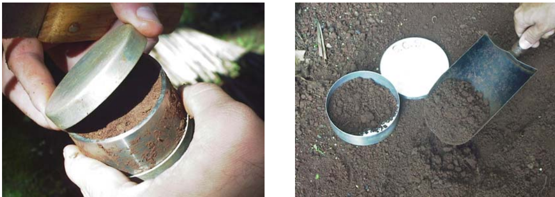
Figura 11 – Métodos de amostragem de umidade: A. Método volumétrico; B. Método gravimétrico com amostras de solo acondicionadas em latas de alumínio.
