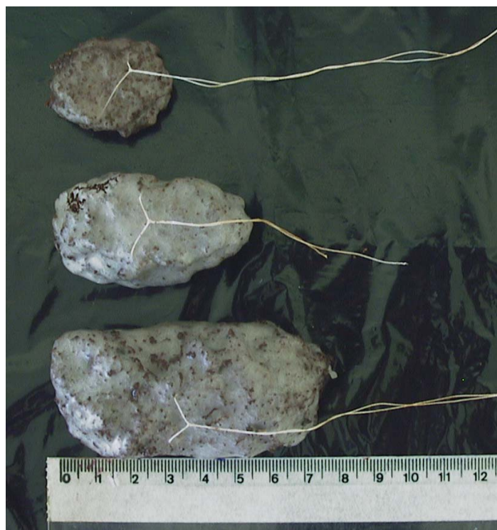
Figura 8 – Diferentes tamanhos de torrões (3 cm, 5 cm e 7 cm) utilizados para obtenção da densidade do solo.
