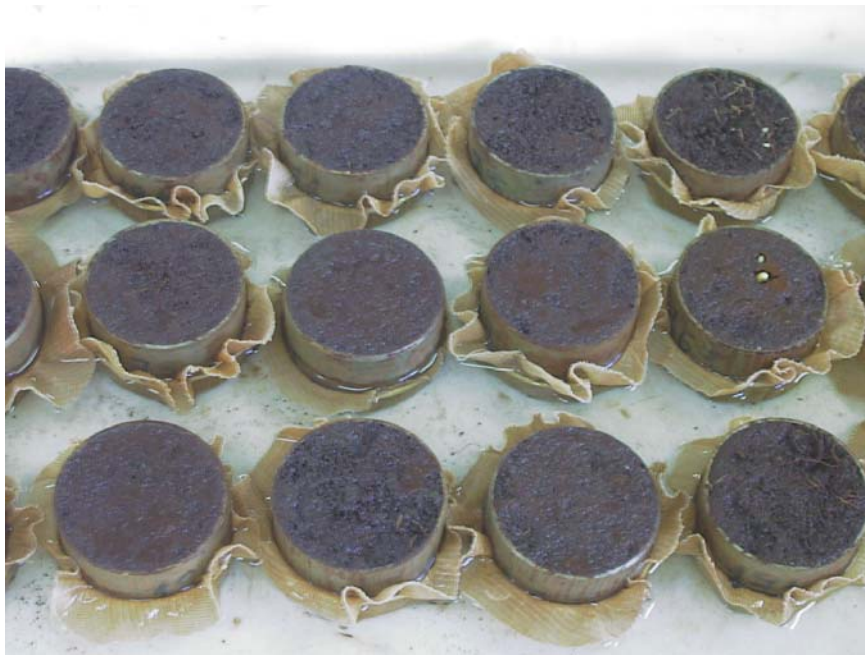
Figura 9 – Amostras indeformadas de solo sendo saturadas para determinação da porosidade total através do método de pesagens.
