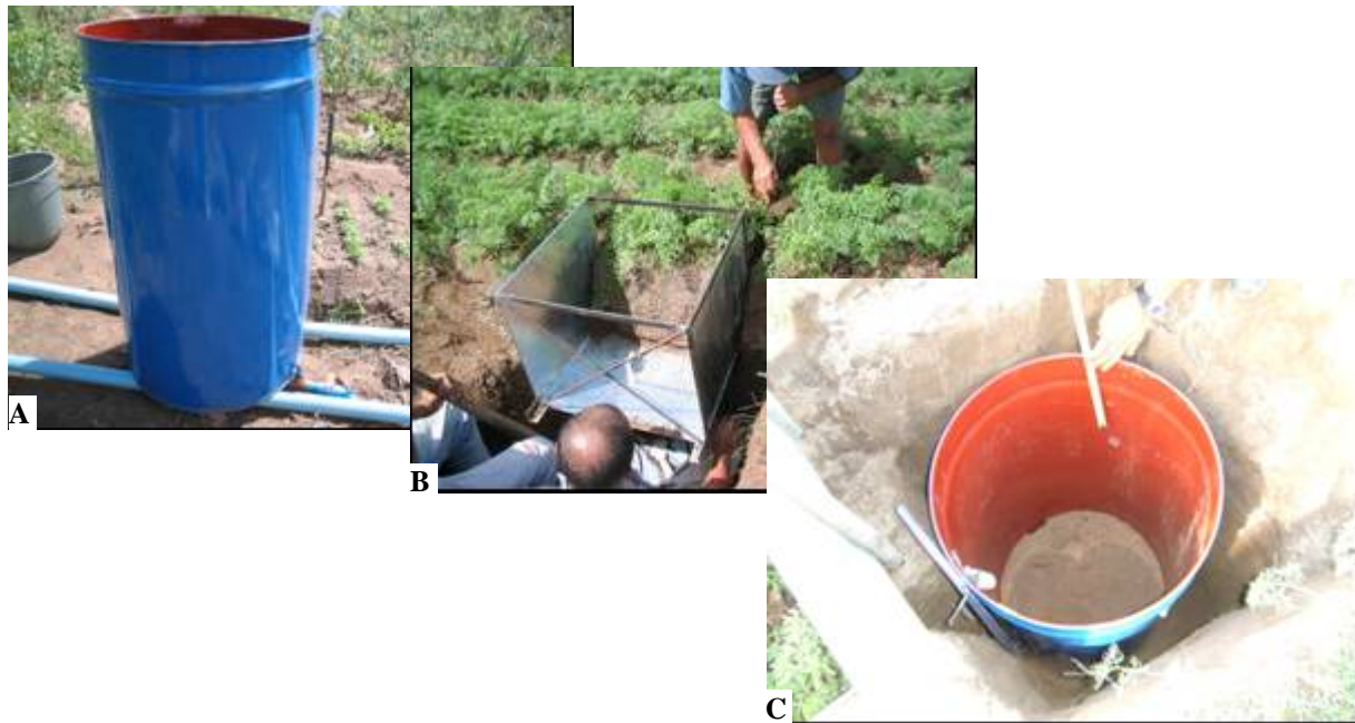
Figura 4.5 – Figura ilustrativa do lisímetro de pequeno porte (A); Estrutura metálica para coleta de monolito com mínima perturbação do solo (B) e Lisímetro instalado (C).
