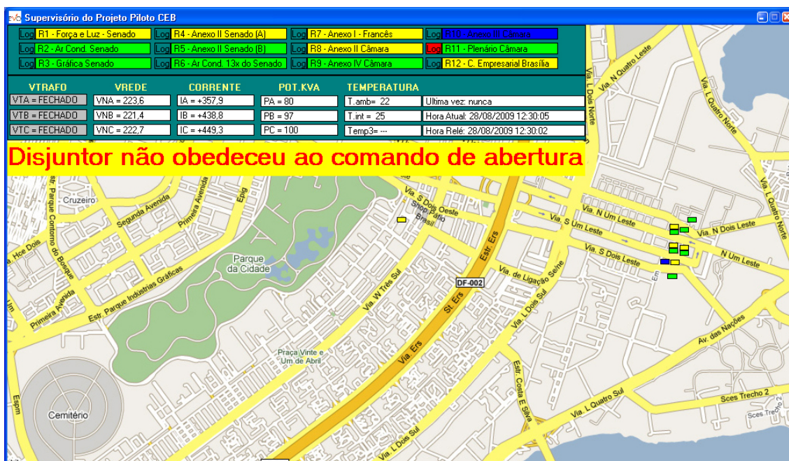
Figura 4.2.2: Tela do programa de PC para monitoramento em tempo real e georreferenciado das unidades instaladas.
