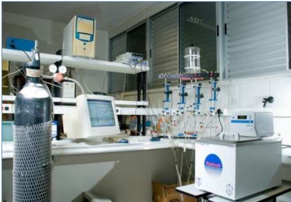
Figura 14 – Sistema para registro de contrações em tecidos isolados Fonte: Laboratório de Farmacologia do Músculo Liso (LAFARMULI)
