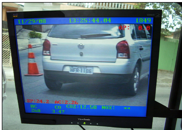
Figura 4.13 – Armazenagem dos dados nos computadores instalados dentro do veículo da empresa.
