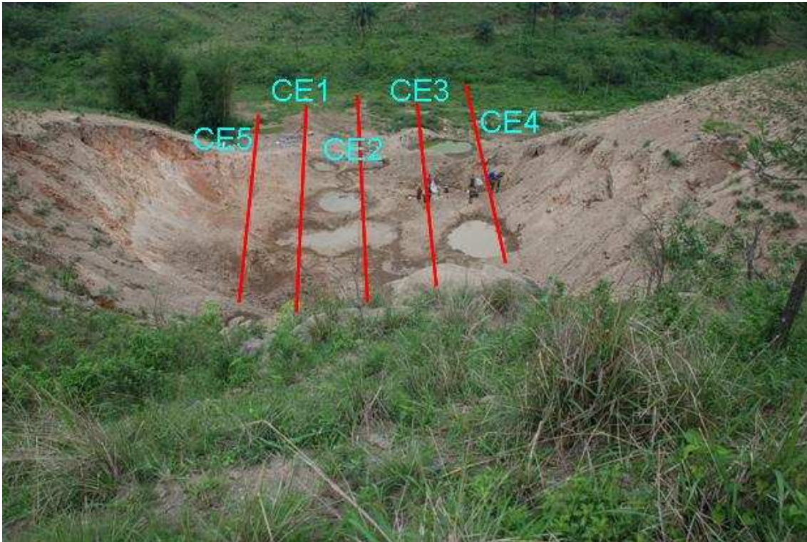
Figura 5.6: Lay-out das Seções (Caminhamentos Elétricos) da ÁREA 1.
