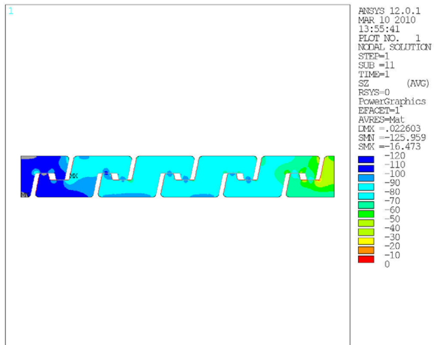
Figura A1-3.- Tensão normal (MPa) da malha de dimensão 0,2 mm e 6 passos.
