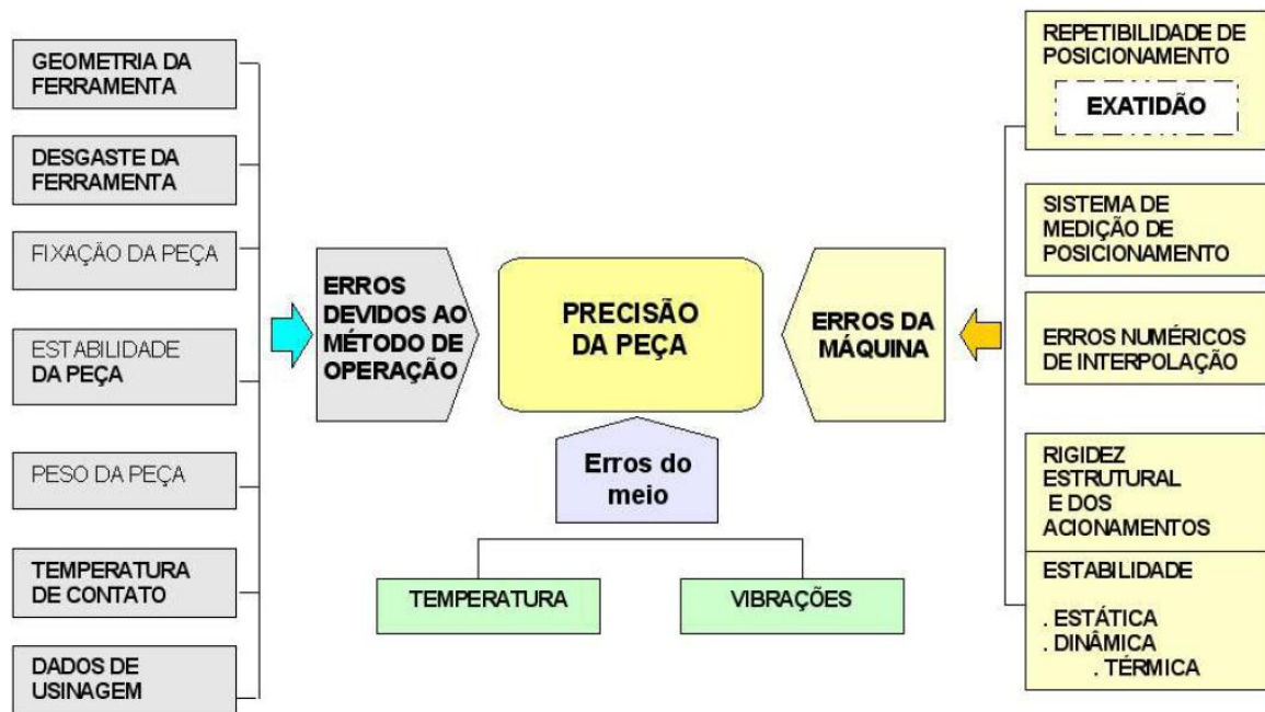
Figura 12 - Parâmetros que influenciam a qualidade de uma peça usinada. Fonte: Stoeterau, 2004.
