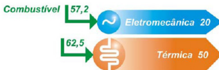
Figura 2.6 - Produção de energia térmica e eletromecânica em separado. Fonte: BARJA, 2006.
