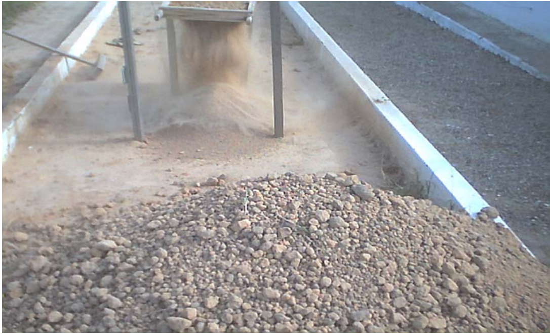
Figura 3. Processo de tamização do material de solo.
