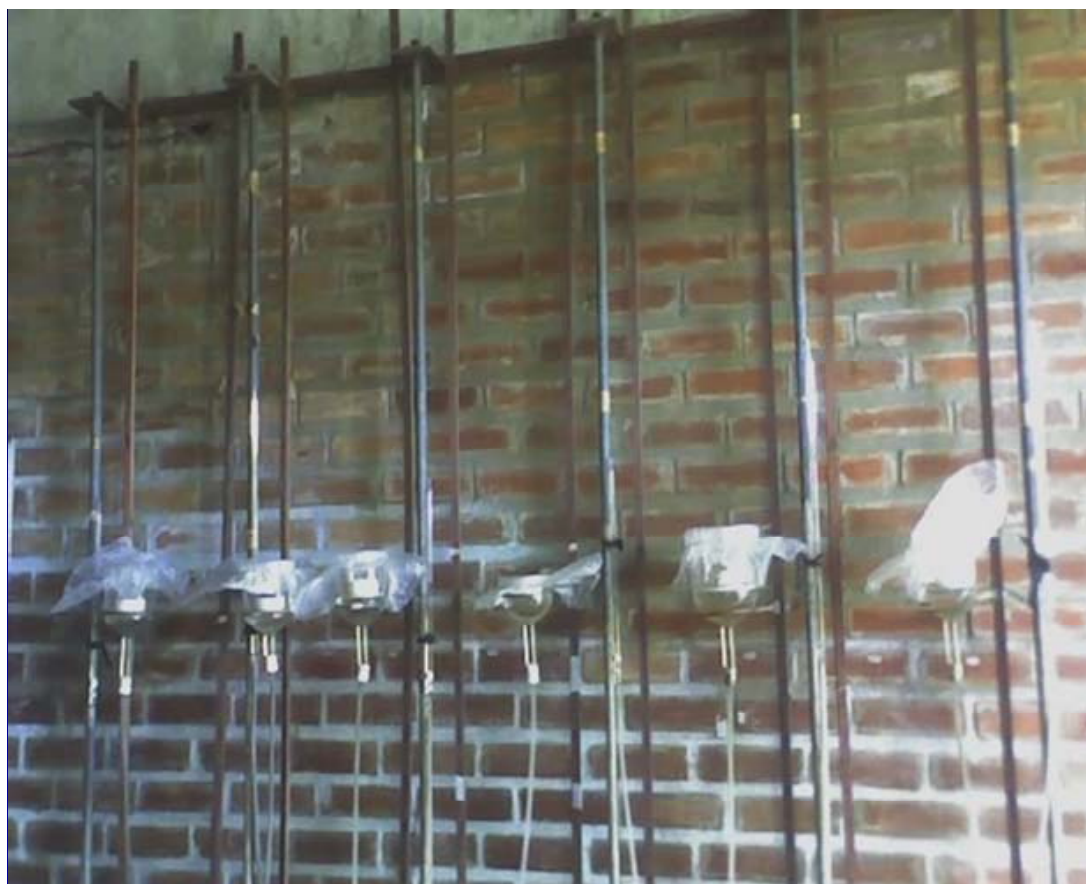
Figura-8 -Funil de placa porosa (funil de Bückner) com amostras de solo submetidas a sucção (-1, -3, -5, -10, -15, -20, -30, -40 -50, -60) de coluna de água.
