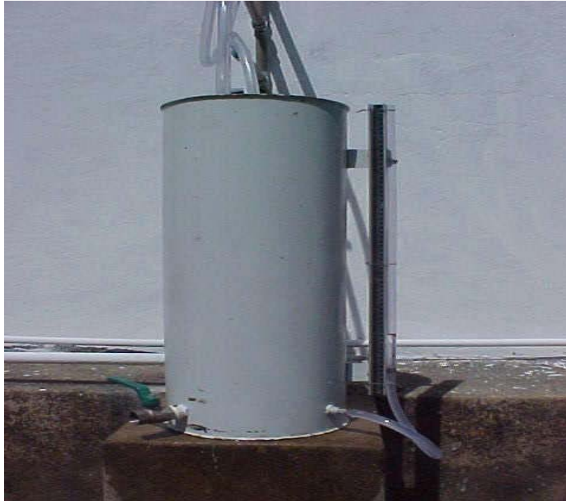
Figura 5. Cilindro coletor com piezômetro previamente calibrado.
