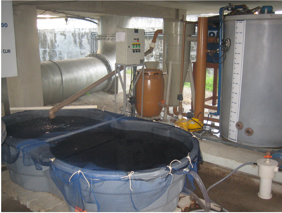
Figura 7 - Aquário construído para os ensaios de toxicidade crônica.
