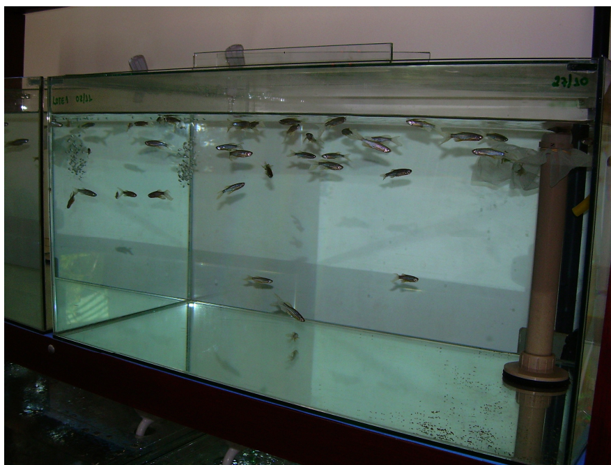
Figura 4 - Peixes Danio rerio em aclimação em aquário para os ensaios de ecotoxicidade aguda.
