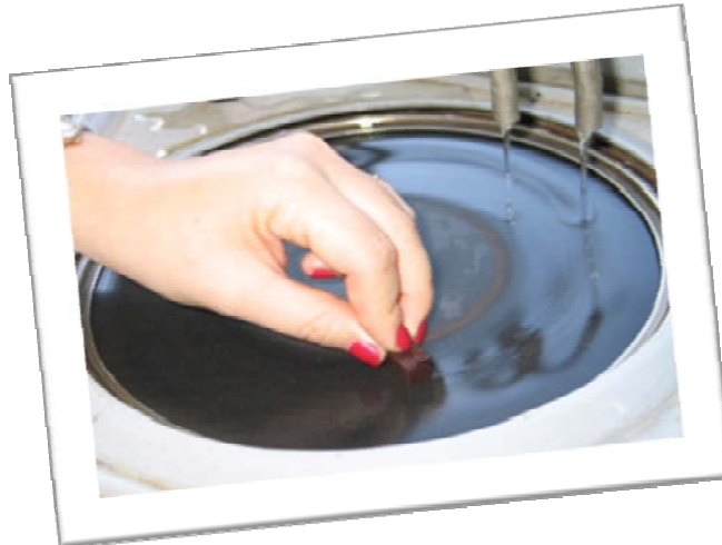
Figura 3.3.7.8: Desbaste dos corpos-de-prova utilizando uma lixadeira.
