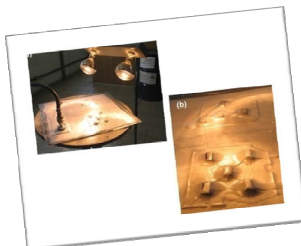
Figura 3.3.7.7: (a) Bolsa de vácuo utilizada na preparação dos CDP's e (b) Corpos-de-prova dentro da bolsa de vácuo (21, 22, 23 24) .
