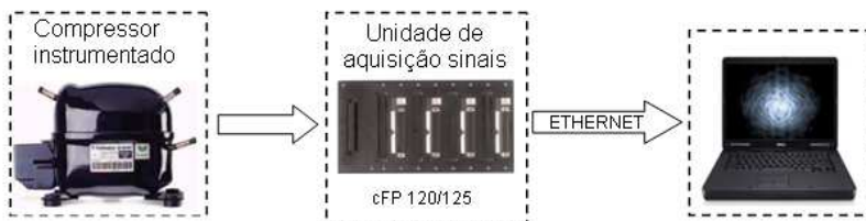
Figura 56- Cadeia de medição temperaturas do compressor.
