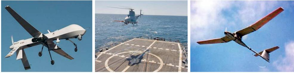
Figura 1.1: Alguns dos VANTs utilizados pelas forças armadas norte-americanas: *MQ-1 Predator*, usado para vigilância e disparo de mísseis; helicóptero *MQ-8B Fire Scout*, que dá apoio ao Exército e Marinha; e o *FQM-151 Pointer*, lançado a mão para sensoriamento remoto.
