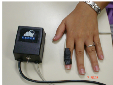
Figura 4.3 – Acelerômetro utilizado para registrar o movimento do dedo indicador da mão esquerda.
