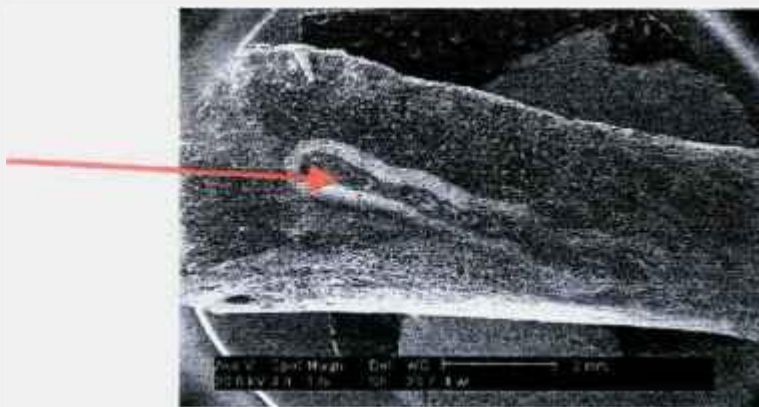
Figura 17. M.E.V. com 4 W de potência imediatamente após (12 x de aumento). Seta vermelha mostra área de resolidificação.
