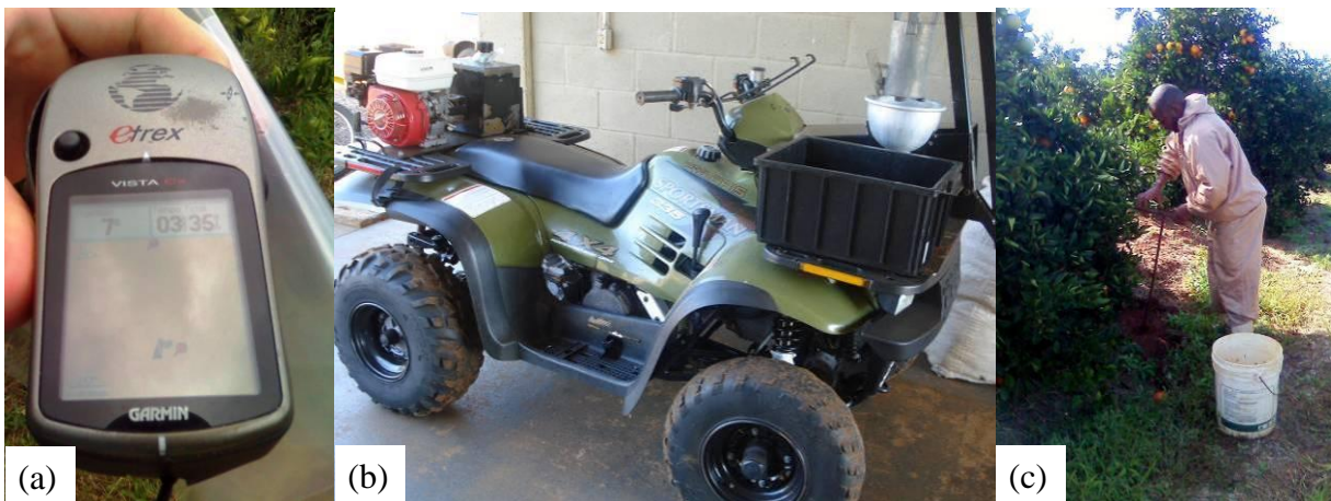
Figura 7 - Receptor GPS (a), quadriciclo usado na amostragem de solo mecanizada (b) e amostragem de solo manual com auxílio de trado holandês (c)
