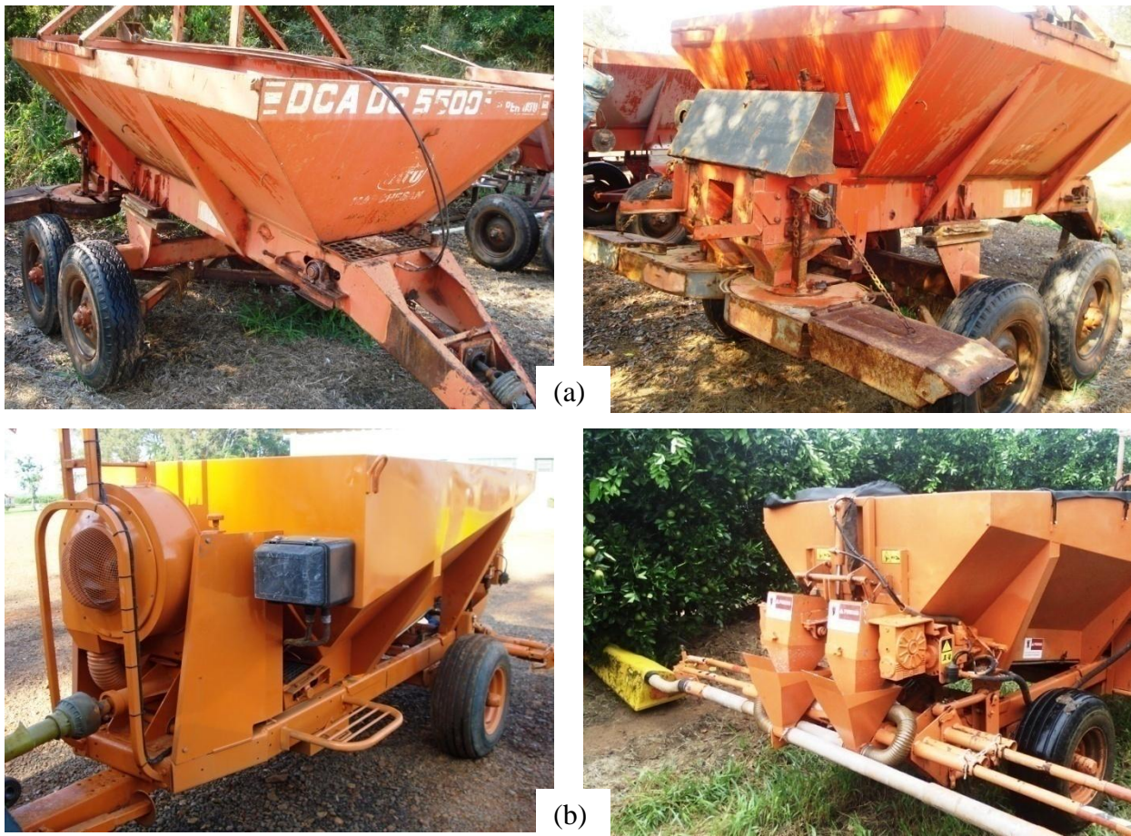
Figura 8 - Máquina adubadora utilizada nas aplicações em dose fixa (a) e máquina adubadora protótipo (b) utilizada na aplicação de doses variadas de fertilizante sólido
