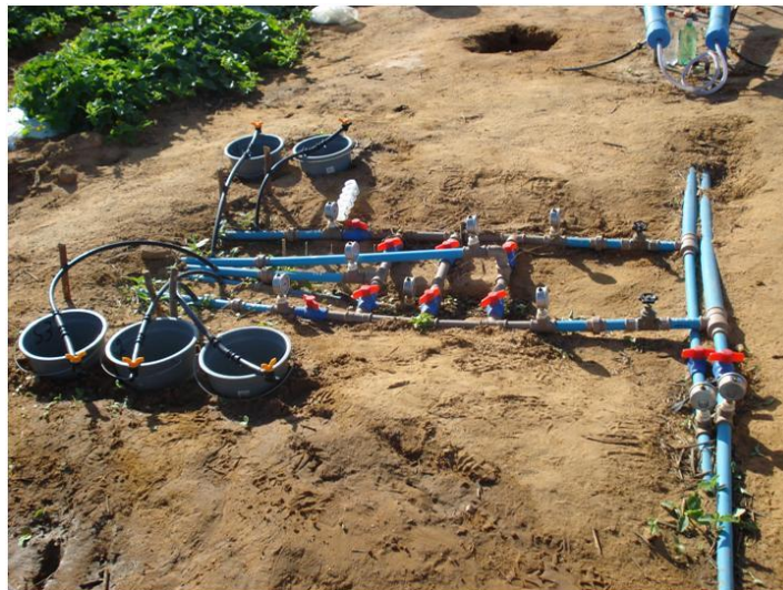
Figura 7. Cabeçal de controle do sistema de irrigação. Mossoró-RN, 2008
