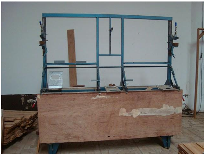
Figura 5.10 – Máquina centro de montagem de porta pronta Fonte: Autor
