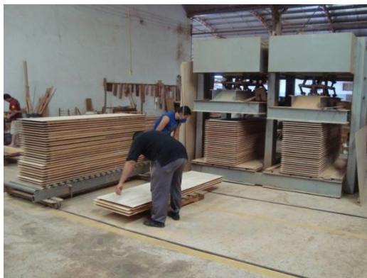
Figura 5.17 – Prensagem das folhas de portas Fonte: Autor
