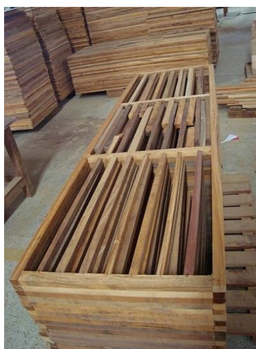
Figura 5.7 – Núcleo das portas prontas de madeira Fonte: Autor
