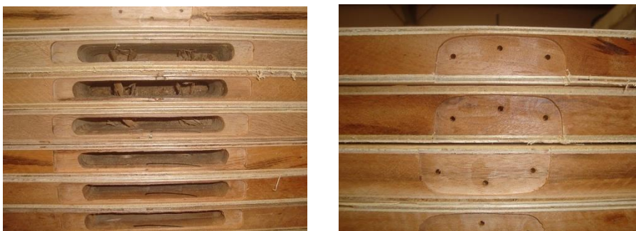
Figura 5.11 – Detalhe do rasgo da dobradiça Fonte: Autor
