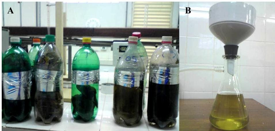
Figura 2. Método de lavagem das folhas: A - Garrafas PET para coleta de folhas de pinhão-manso; B - Funil de Büchner e Kitassato do conjunto de filtragem. Fotos: Diego Macedo.
