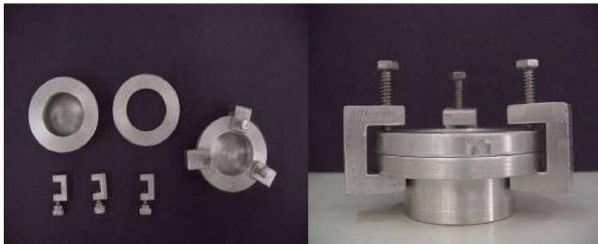
Figura 2. Cúpula de permeabilidade (*Payne permeability cup*, Braive Instruments, Liège, Bélgica)
