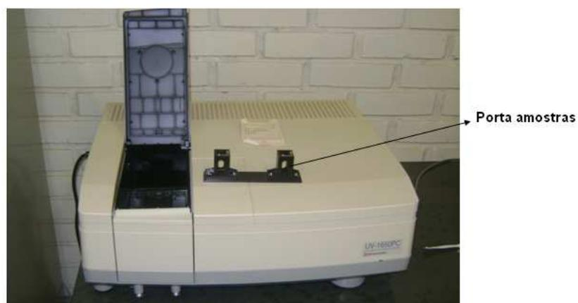
Figura 4.6: Espectrofotômetro UV-Visível do LAMUTA/UFMT utilizado neste trabalho.
