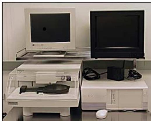
Figura 4.1: Equipamento Tencor Alpha Step 500, utilizado para determinar as espessuras dos filmes neste trabalho.
