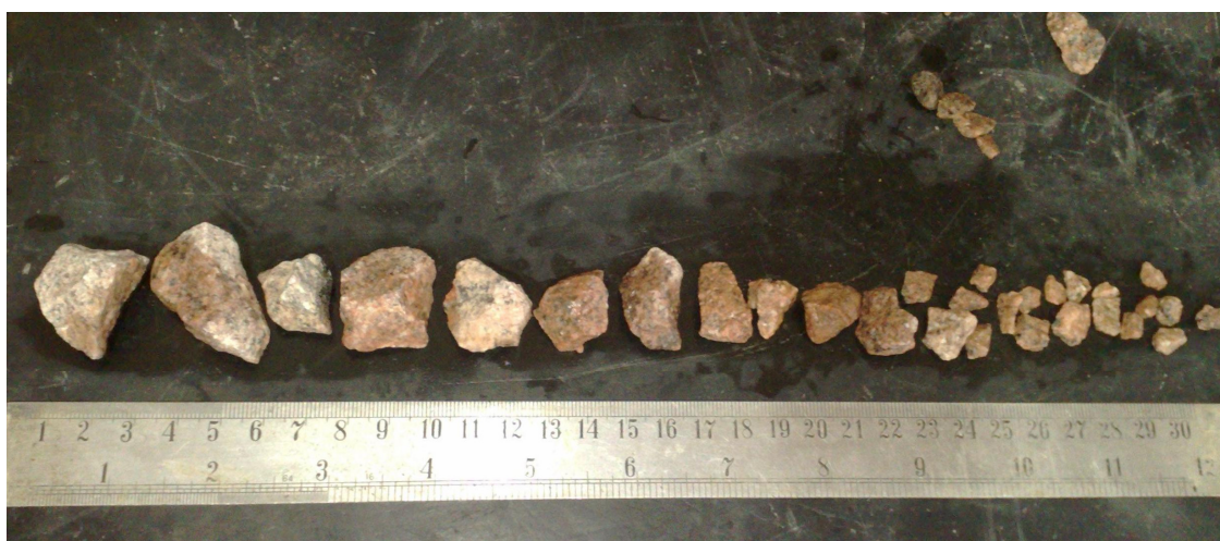
Figura 3.8 – Fotografia ilustrando a fração do agregado graúdo de menor dimensão.
