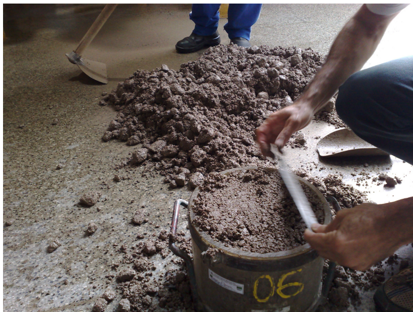
Figura 3.15 – Preparação do CCR para o ensaio Cannon Time .
