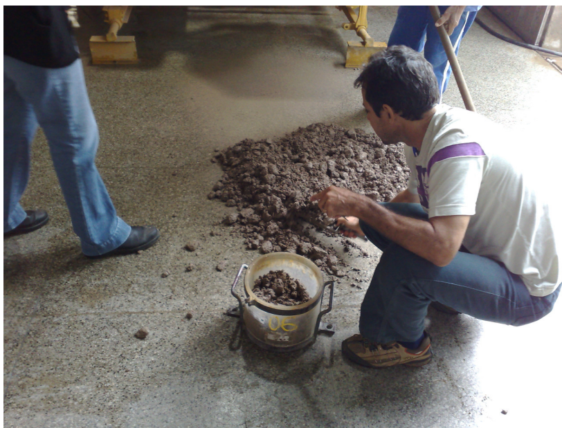
Figura 3.14 – Preenchimento do cilindro de acrílico com a mistura seca do CCR.
