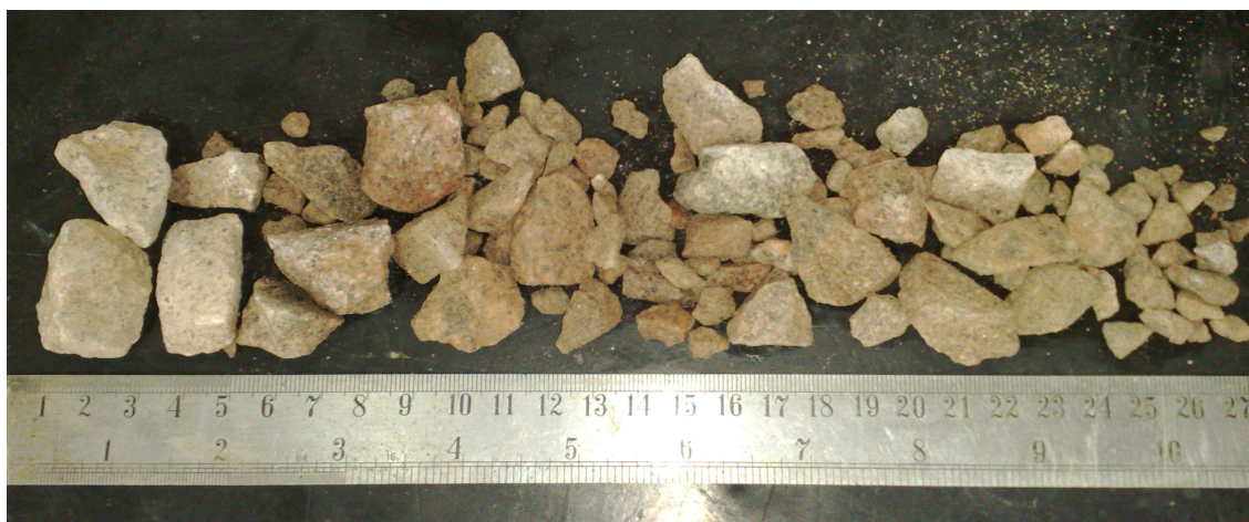
Figura 3.9 – Fotografia ilustrando a mistura das frações dos agregados graúdos de maior e menor dimensão.
