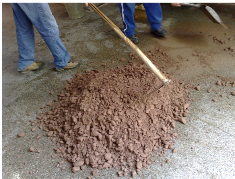
Figura 3.21 – Mudança na cor do concreto após a substituição de 35% do volume de cimento pela pozolana.
