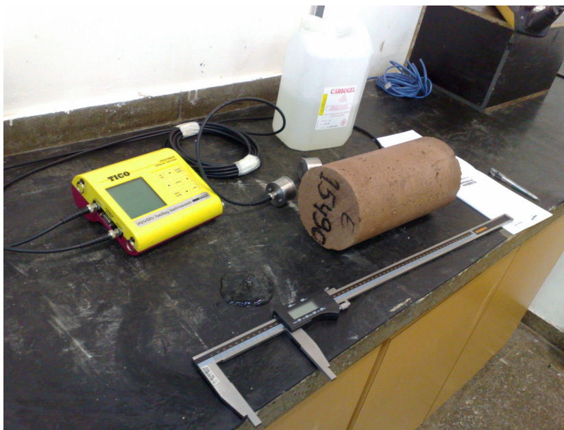
Figura 3.18 – Aparelhos usados para realizar o ensaio de ultrassom.
