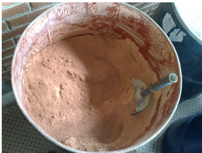
Figura 3.3 – Aspecto da pozzolana de argila calcinada utilizada neste estudo.
