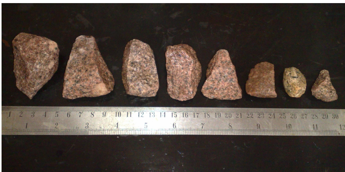
Figura 3.7 – Fotografia ilustrando a fração do agregado graúdo de maior dimensão.
