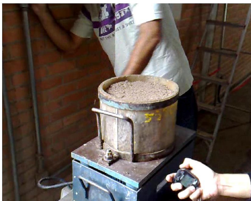
Figura 3.16 – Ensaio Cannon Time em andamento.
