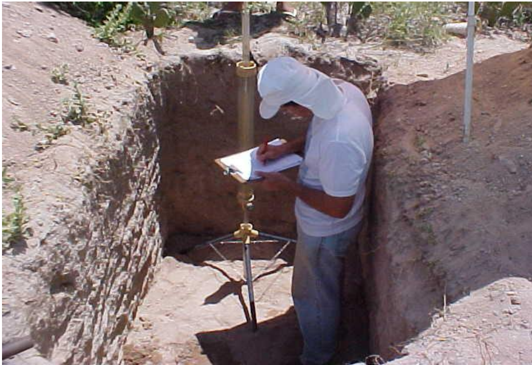
Figura 7 Permeâmetro de Guelph montado no campo (perfil1).
