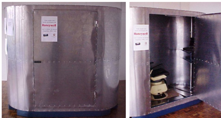
Figura 4 - Ambiente com conceito de Gaiola de Faraday desenvolvido no Laboratório de Biosinais UCS_CARVI
