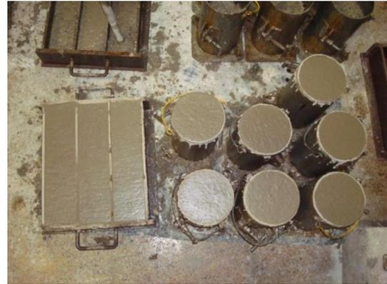
(a) Moldagem dos corpos de prova para caracterização do concreto
