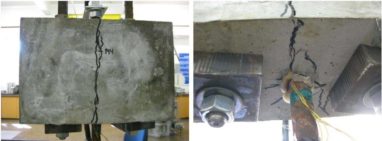
(a) Fissuração na direção do menor cobrimento
