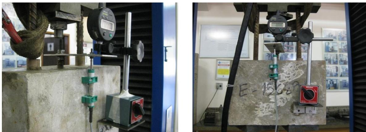
Figura 3.19 – Detalhe de fixação do transdutor de deslocamento e do relógio comparador ao corpo de prova.
