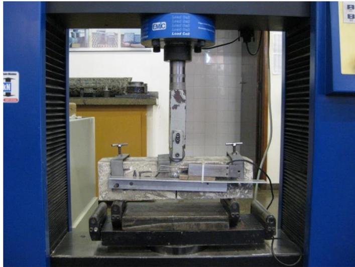
Figura 3.11 – Ensaio de flexão sob três pontos de carga
