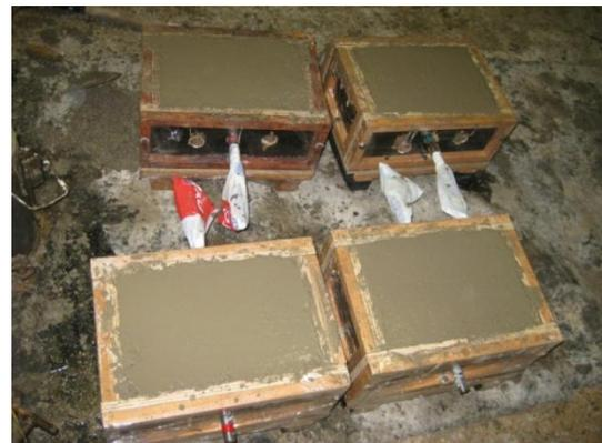
(b) Moldagem dos corpos de prova para o ensaio de arrancamento
