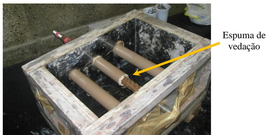
Figura 6.4 – Esquema de criação da região sem aderência (uso de espuma)
