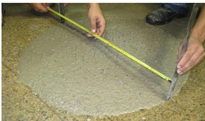
(c) Espalhamento (*slump flow test*)
