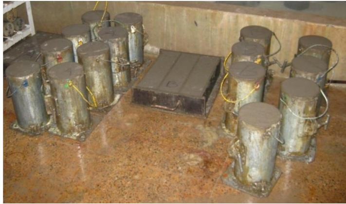
Figura 3.5 – Corpos de prova na câmara úmida
