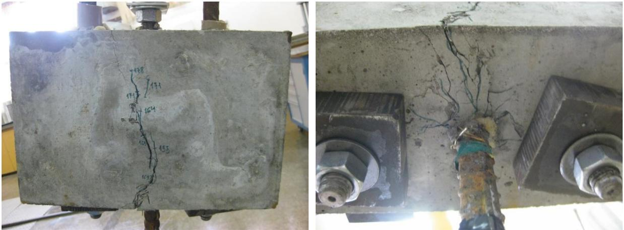
(a) Fissuração na direção do menor cobrimento
