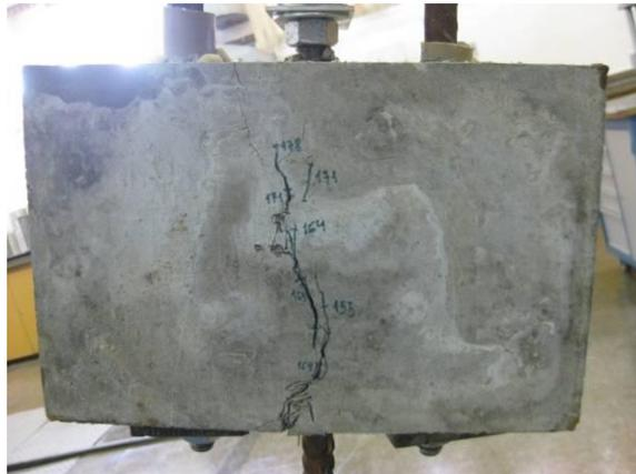
(a) Bloco fissurado (barra de 20 mm)
