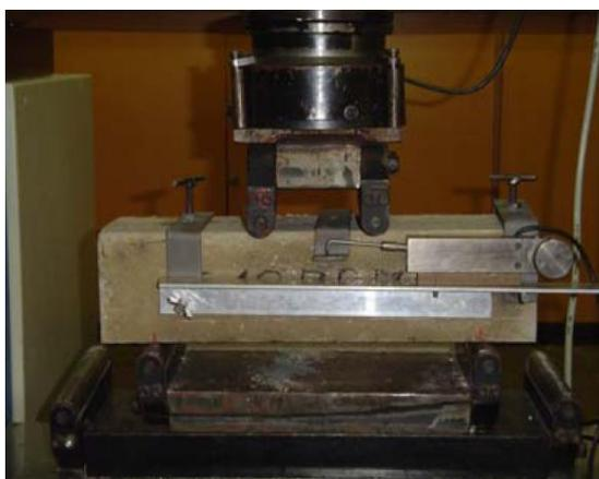
Figura 3.14 – Ensaio de flexão sob quatro pontos de carga
