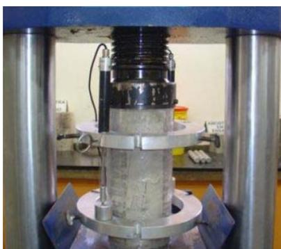
Figura 3.9 – Ensaio de compressão com deslocamento controlado (OLIVEIRA JUNIOR, 2007)
