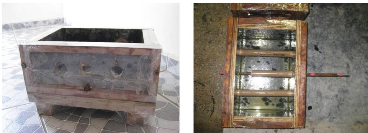
Figura 3.16 – Formas para ensaio de arrancamento
