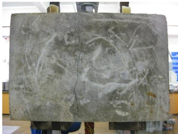
Figura 5.33 – Formação de fissura nos corpos de prova fibrosos (CP20.5.2.B)
