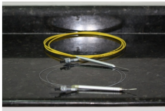
FIGURA 5: Fibra óptica para uso em alta e baixa intensidade
