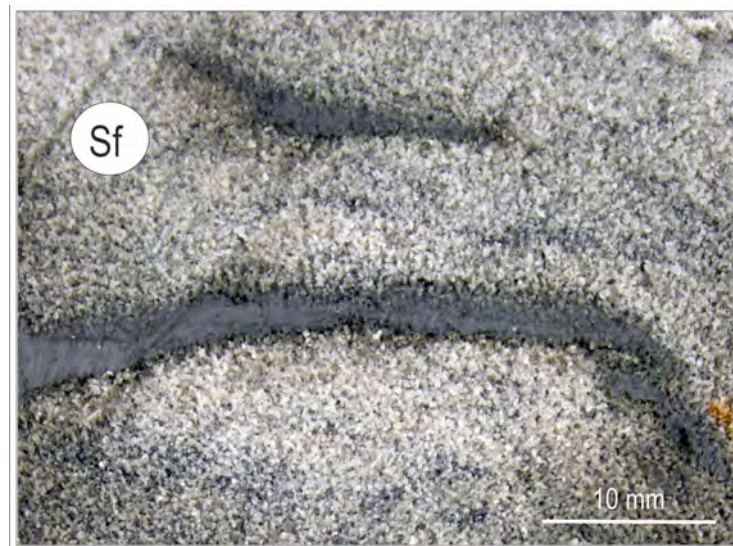
Figura 34: Fácies areia com acamamento flaser (Sf), no testemunho S03, areal das Ilhas III.
