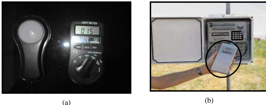
Figura 8 - Luxímetro e estação automática localizada no posto meteorológico
