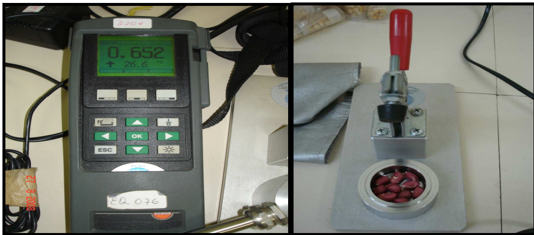
Figura 9 - Aparelho utilizado para determinação da atividade da água no grão e na casca do amendoim
