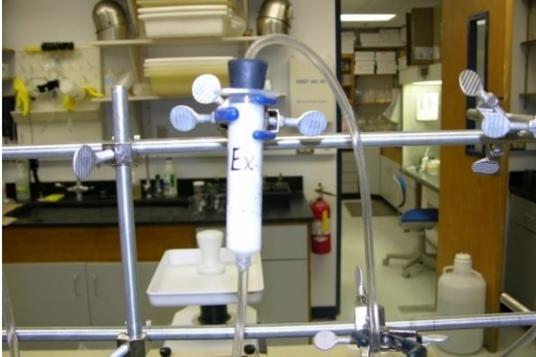
Figura 2 - Extremidades da coluna com entrada e saída dos tubos de condução da solução.
