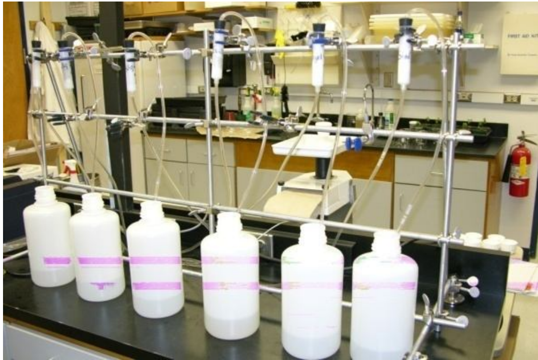
Figura 3 - Estrutura e suporte da coluna, junto aos coletores da solução passante pelas amostras.
