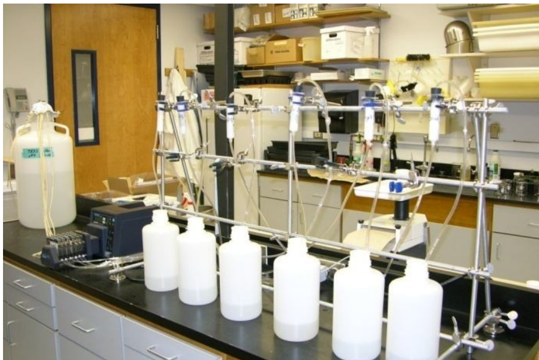
Figura 5 – Solução TRIS sendo lixiviada pelas colunas contendo os fertilizantes.
