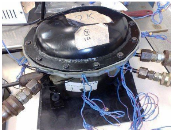
Figura 4.31 – Compressor de tampa flangeada, instrumentado com termopares.
