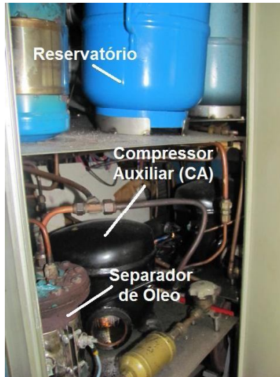
Figura 4.3 – Interior da bancada de ensaios de partida e de tombamento.
