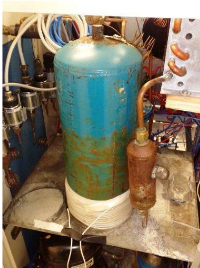
Figura 4.19 – Resistor aquecedor de revestimento de silicone, instalado em torno da base do reservatório.
